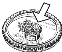
Dosierkapsel beim Befüllen mit Magazineckel (Trichter)
